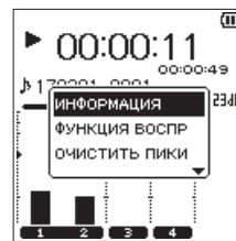
Быстрое меню на главном экране во время воспроизведения в 4-канальном режиме (4CH)
